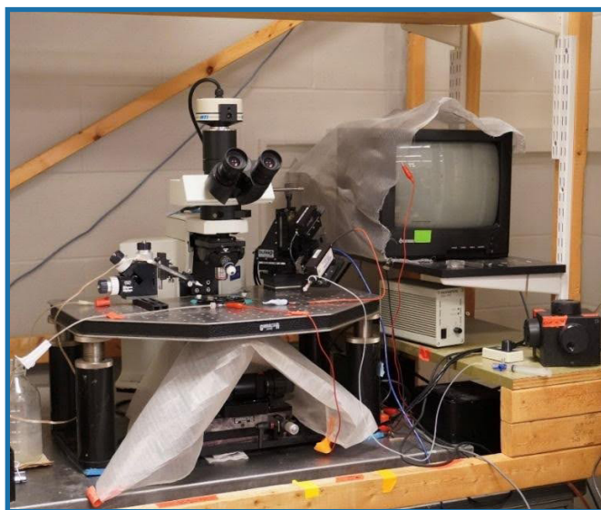
Une installation d'électrophysiologie. Un instrument finement réglé utilisé pour enregistrer les signaux électriques des cellules, utilisé par notre équipe pour étudier les effets des agents anesthésiques généraux sur l'activité neuronale liée aux effets antidépresseurs.
